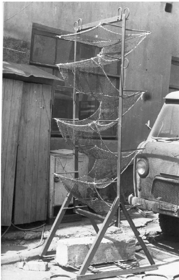
Рисунок 3. Конструкция опорного придонного ИР из каркаса-стойки и делового съемного полотна
