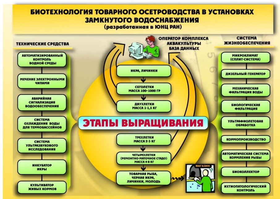
Рисунок 10 – Основные элементы биотехнологии выращивания осетровой товарной продукции в УЗВ
