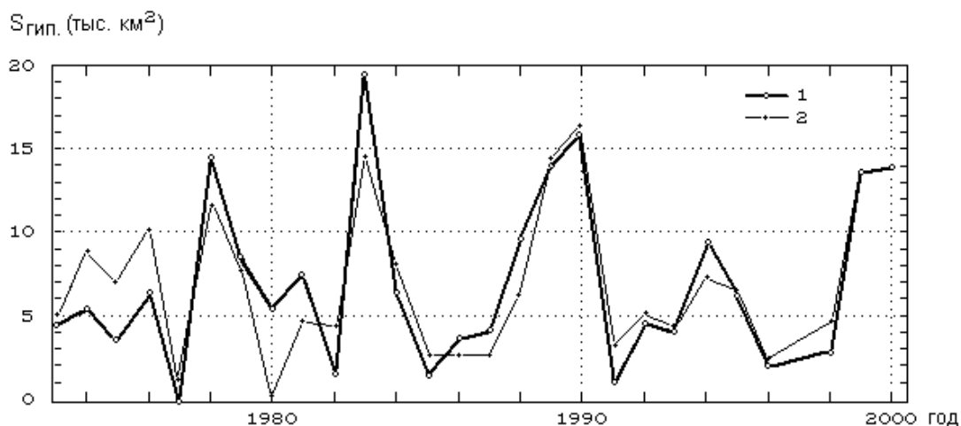
Рисунок 5. Межгодовые изменения площади гипоксии, определенные по натурным данным (1) и рассчитанные по модели (2)
