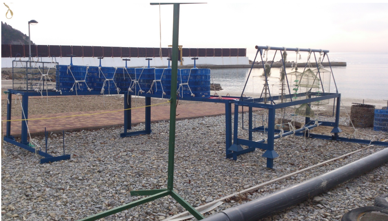
Рис. 3 Донные столы (береговая имитация зигзагообразной установки трех столов на дне), слева – с устричным садком прямоугольным, посередине – с цилиндрическими садками типа «Ostriga», справа – со съемной объемной рамой с полумягкими садками
