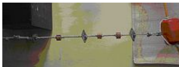
Рисунок 18. Фрагмент мидийного коллектора, с возможностью изменения боковой поверхности
