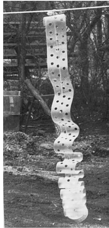
Рисунок 7. Коллектор из перфорированной пластиковой ленты на несущем канате
